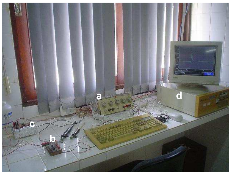
Fig. 1 – Aparato da técnica de single sucrose gap . a) estimulador; b) câmara experimental para captação dos PAC's; c) pré-amplificador de ganho fixo/variável; d) placa conversora A/D (Lynx/Brasil) + PC-compatível.
