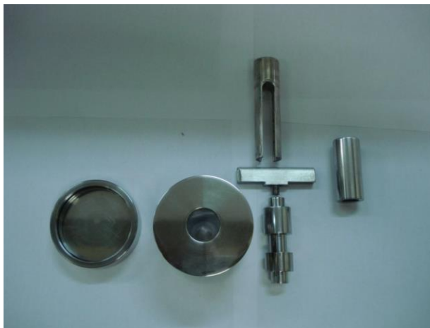
Figura 19 - Matriz de aço, ferramenta utilizada na conformação dos toróides.
