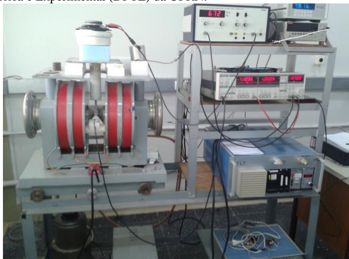
Figura 22 - MAV montado e desenvolvido no Laboratório de Magnetismo e Materiais Magnéticos (LMMM) do Departamento de Física Teórica e Experimental (DFTE) da UFRN.
