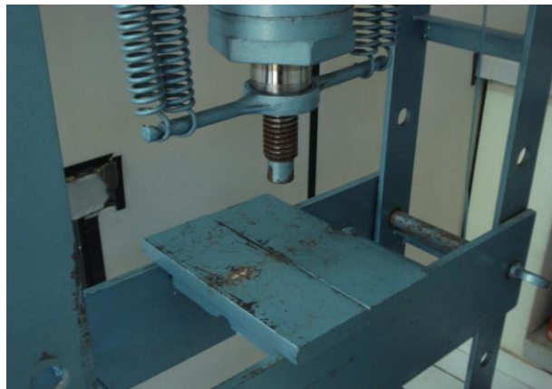
Figura 19 - Matriz de aço, ferramenta utilizada na conformação dos toróides.
