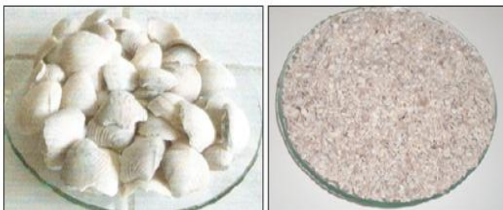
Figura 4.2 - Conchas de marisco antes e após moagem, lavadas, secas e moídas (0,59 mm).
