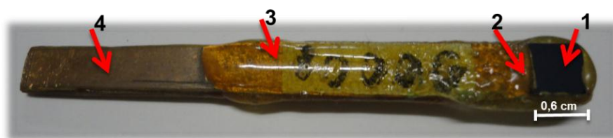
Figura 3.2 – Eletrodo de DDB: (1) filme de DDB; (2) contato elétrico (liga estanho/chumbo); (3) isolamento do contato elétrico com resina epóxi Araldite® e (4) placa de cobre.
