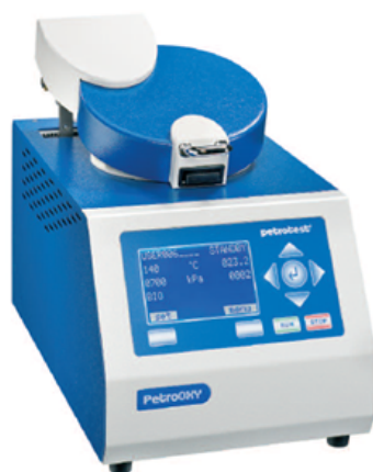
Figura 3.15: Equipamento de medir a estabilidade oxidativa pelo método Petro-OXY. Fonte: (NEUMANN et al. , 2008).
