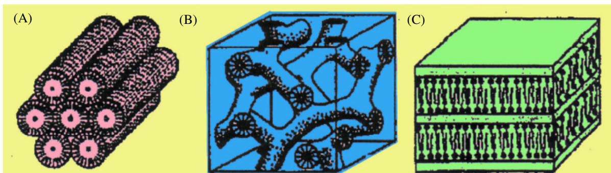
Figura 5 - Ilustração das estruturas (a) MCM-41, (b) MCM-48 e (c) MCM-50 [SOUSA, 2006].
