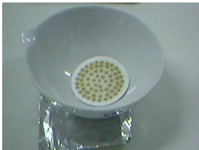
Figura 6.8. Membrana de micro-fibra de vidro imersa na mistura de ácido acético com cloridrato de hidroxilamina.
