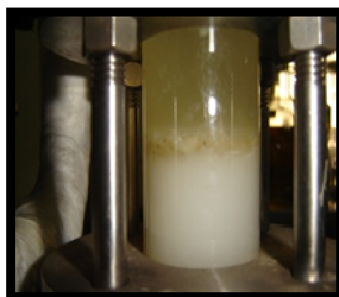
Figura 4.4 – Separação glicerina (parte inferior) / biodiesel (parte superior).
