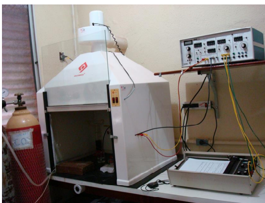
Figura 2.3. Bipotenciostato AFRDE 5 e registrador 720M-30-XY. Fonte: Pesquisa direta (2010).
