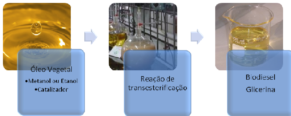
Figura 3.5 - Processo de transesterificação
