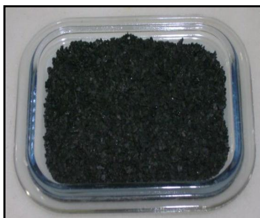
Figura 4.3. Carvão de endocarpo de coco da baía ativado quimicamente com \text{H}_3\text{PO}_4
