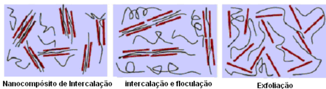
Figura 1.5 Representação dos diferentes tipos de nanocompósitos formados entre um polímero e um silicato lamelar.
