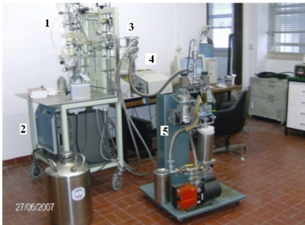
Figura 5.2: Sistema utilizado neste trabalho, composto de (1) linha de vácuo, (2) compressor do criostato, (3) criostato, (4) espectrômetro de FTIR e (5) bombas de vácuo.
