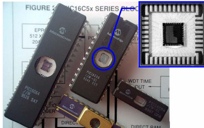
Figura 1.16. Microcontroladores. O destaque em azul mostra o detalhe da configuração física do interior de um microcontrolador ( chip ).
