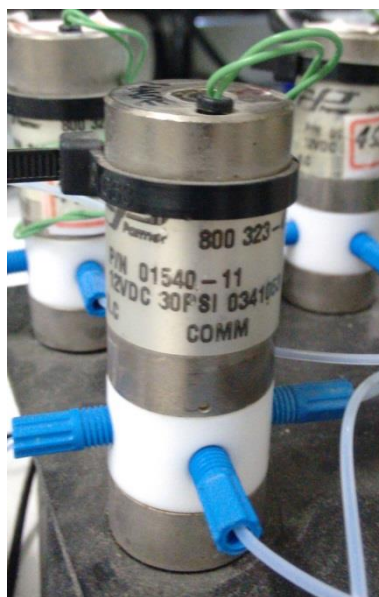
Figura 2.7. Válvula solenoide de três vias utilizada no sistema FBT-DM.
