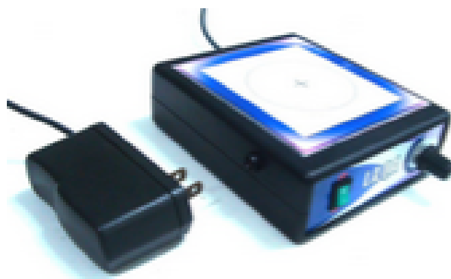
Figura 2.5. Agitador magnético utilizado no sistema FBT-DM.
