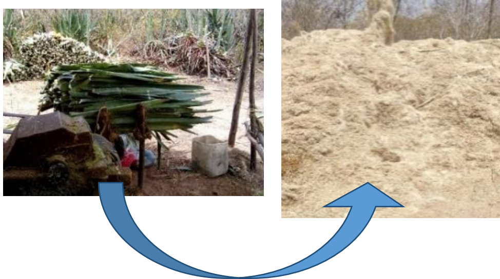
Figura 12: Processamento do sisal e geração de resíduos sólidos.
