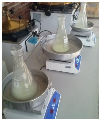
Figura 17: Sistema de Banho Maria para a obtenção de holocelulose.
