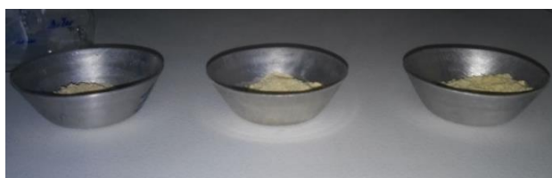
Figura 13: Determinação do teor de umidade no bagaço de sisal
