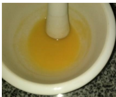
Figura 18: Holocelulose em contato com uma solução de hidróxido de sódio para determinação da alfa-celulose.
