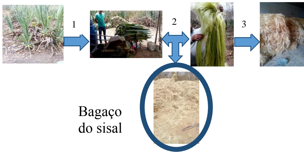
Figura 1 – Processamento da fibra do sisal e geração de resíduos
