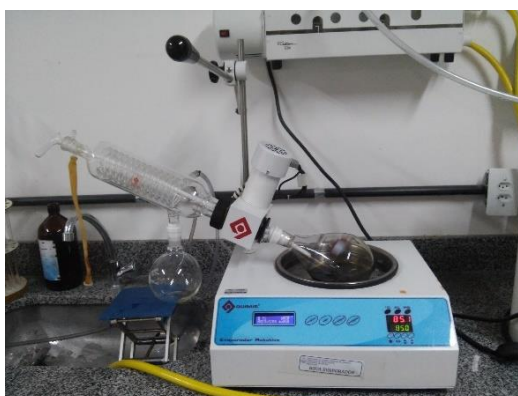
Figura 25: Concentração do licor para remoção de inibidores fermentativos.
