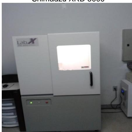
Sistema de filtragem: Monocromador secundário de grafite curvo. Os difratogramas foram obtidos na faixa de  $2\theta$  de 20 a 60 graus em modo contínuo a  $2^\circ/\text{min}$ . O tamanho médio do cristalito foi calculado a partir do alargamento de raios-X ( $d_{311}$ ), através da deconvolução da linha de difração secundária do silício policristalino (utilizado como padrão) usando-se a equação de Scherrer (PEELAMEDU *et al.*, 2003).
