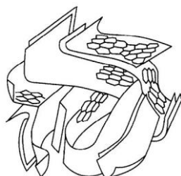
Figura 3.1 – Representação esquemática da estrutura do carvão ativado (RODRIGUEZ-REINOSO (1998)).
