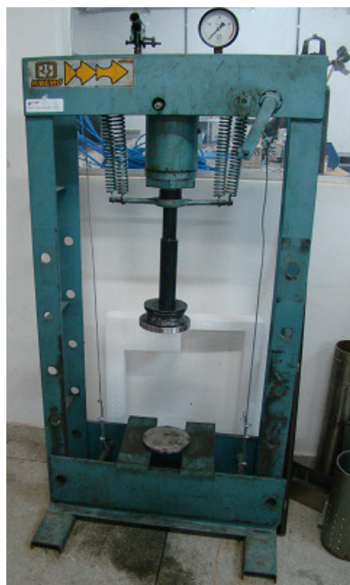
Figura 4.1 – Prensa mecânica utilizada na obtenção dos óleos vegetais.
