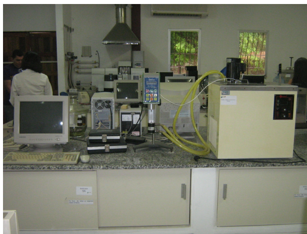
Figura 4.2 - Viscosímetro usado no estudo reológico dos óleos vegetais.
