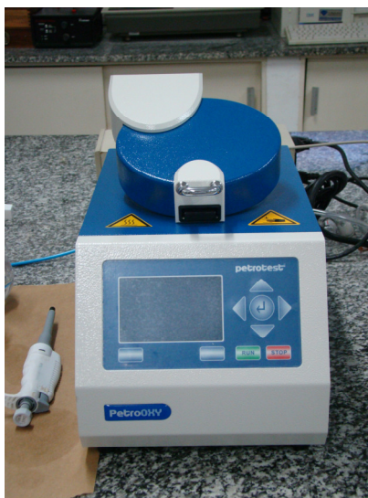
Figura 4.5 - Aparelho PetroOxy usado para determinar o período de indução das amostras de óleo vegetal.
