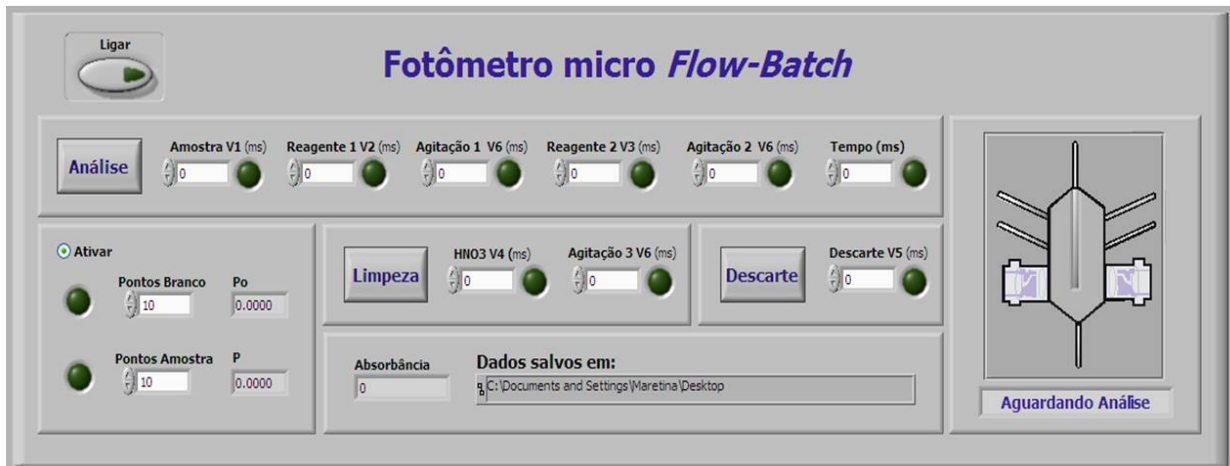
Figura 2.8 - Interface de controle automático do \mu FBA para análise de taninos em chás.
