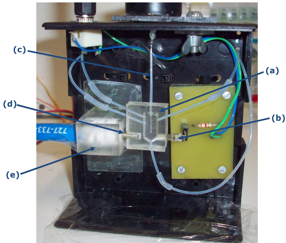
Figura 2.3 – Imagem do sistema \mu FBA desenvolvido para análise dos corantes. (a) dispositivo microfabricado, (b) LED branco, (c) agitador, (d) fibra óptica do ocean optics e (e) suporte de acrílico.
