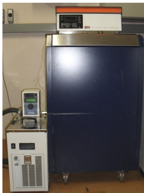
Figura 3.3 Representação esquemática do calorímetro LKB 2277 e sua foto
