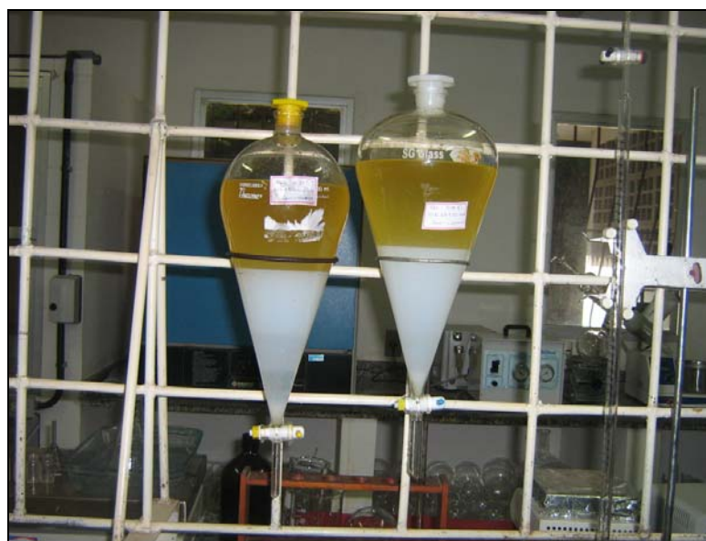
Figura 5. Lavagem do biodiesel em escala laboratorial.
