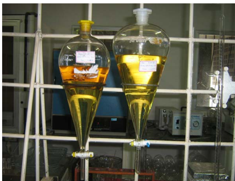
Figura 4. Biodieseis etílicos após a retirada da glicerina.
