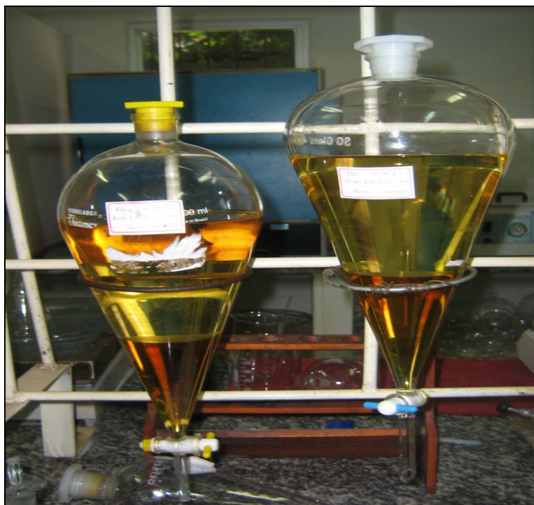
Figura 3. Separação da glicerina e do biodiesel etílico.
