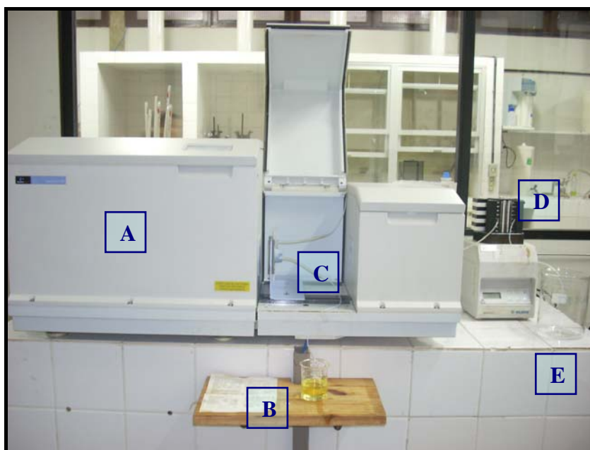
Figura 2.3. Sistema para registro dos espectros NIR dos óleos vegetais. A: espectrômetro NIR; B: amostra de óleo vegetal; C: cubeta de fluxo de quartzo; D: bomba peristáltica; E: descarte.
