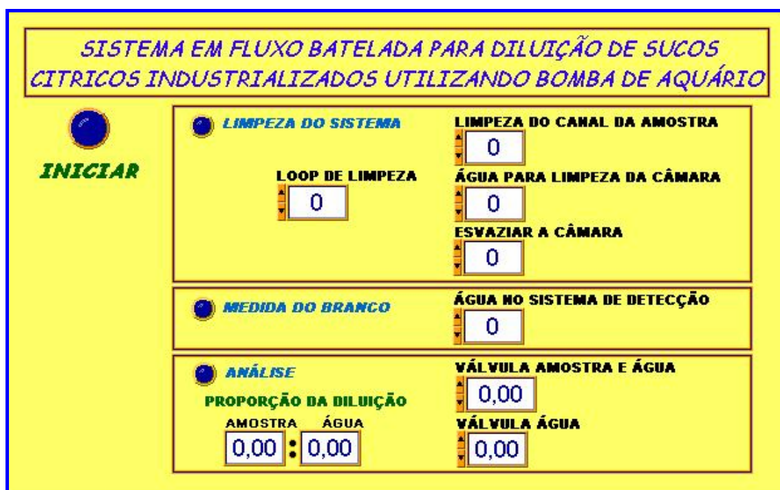
Figura 11. Tela do menu principal do Software de controle e aquisição de dados do sistema fluxo-batelada com bomba de aquário.
