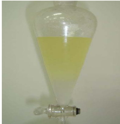
Figura 4.6. Processo de lavagem do biodiesel na rota etílica.
