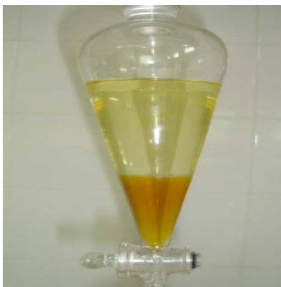
Figura 4.4. Separação da glicerina e do biodiesel de canola na rota etílica.
