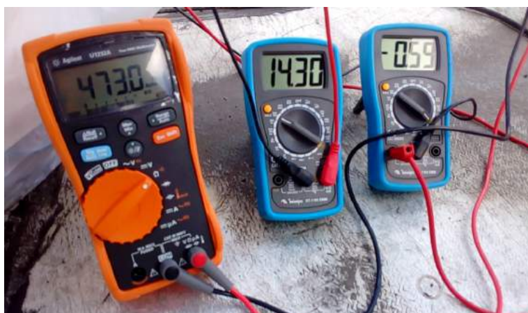
Figura 74. Medições manuais. De esquerda pra direita: Resistência total dos 4 sensores para obter a temperatura traseira do painel superior (ohms), tensão de saída (Volts) e corrente de saída (Ampers), do 20 de agosto de 2016 as 15:30h aproximadamente. Fonte: Autoria própria.
