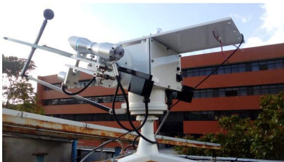
Figura 69. SunTracker EKO® instalado na estação meteorológica do CEAR. Fonte: Aatoria própria.
