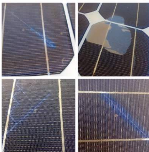
Figura 73. Algumas das células quebradas em alguns dos módulos instalados. Fonte: Autoria Própria.
