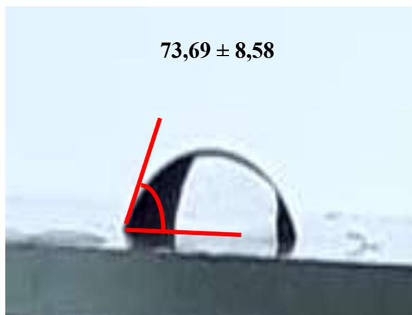
**Figura 32:** Imagem da determinação de ângulo de contato para Filme de PVC.
