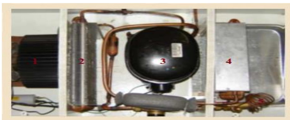
Figura 3.3 - Vista superior da bomba de calor e seus componentes: ventilador (1), condensador (2), compressor (3), evaporador (4) e dispositivo de expansão (5).
