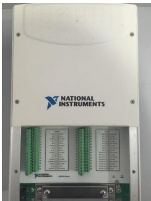
Figura 4.7 - Interface de aquisição, família NI-USB 62XX, National Instruments Corporation (Flores, 2021).
