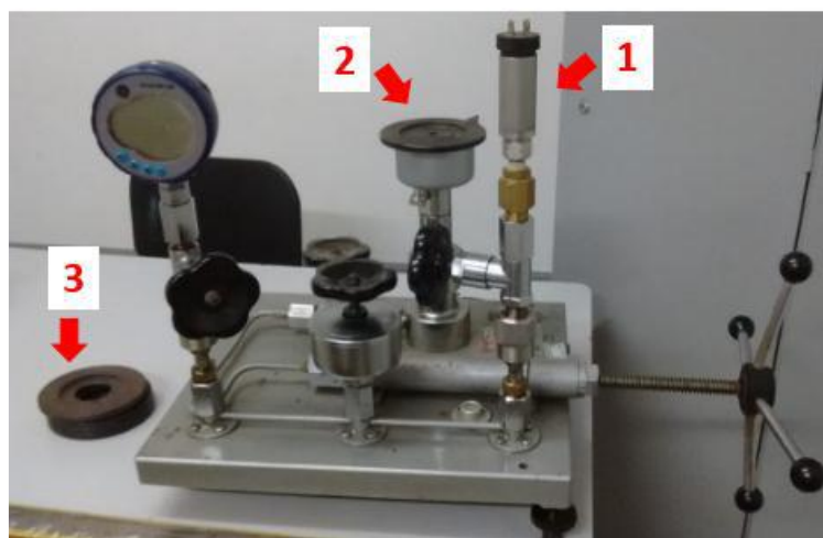
Figura A1 - Balança de peso morto utilizado para ajuste dos sensores de pressão.
