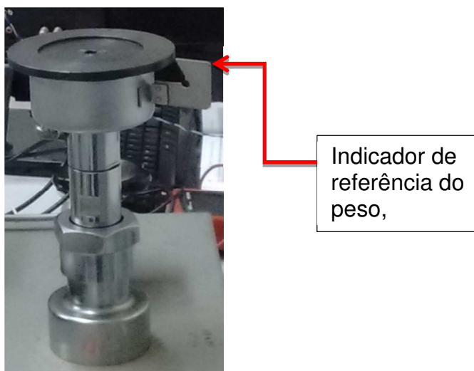
Figura A.2 – Detalhe da indicação do peso.
