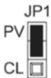
Figura A.7 – Posição de operação normal do jumper JP1. Fonte: CATÁLOGO INCONTROL (2016).
