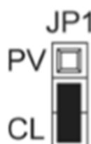
Figura A.6 – Posição do jumper JP1 para calibração de 20 mA. Fonte: CATÁLOGO INCONTROL (2016).
