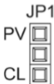
Figura A.10 – Posição do jumper JP1 para calibração de 4 mA. Fonte: CATÁLOGO INCONTROL (2016).
