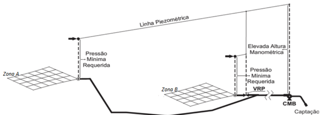
Figura 3 - Setorização com dois setores com uso de VRP
