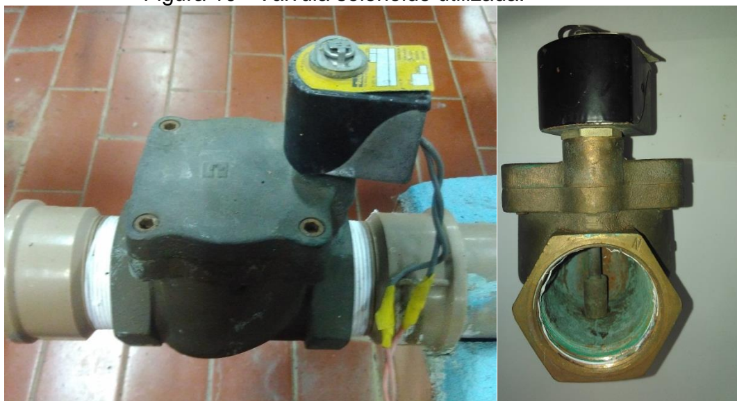
Figura 10 - Válvula solenoide utilizada.
