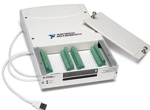
Figura 4. 6 - Módulo de aquisição de dados da National Instruments – USB 6229.
