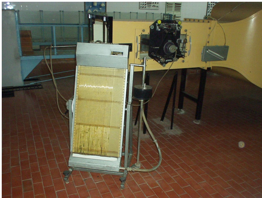
Figura 22 - Foto do quadro de manômetros diferenciais
