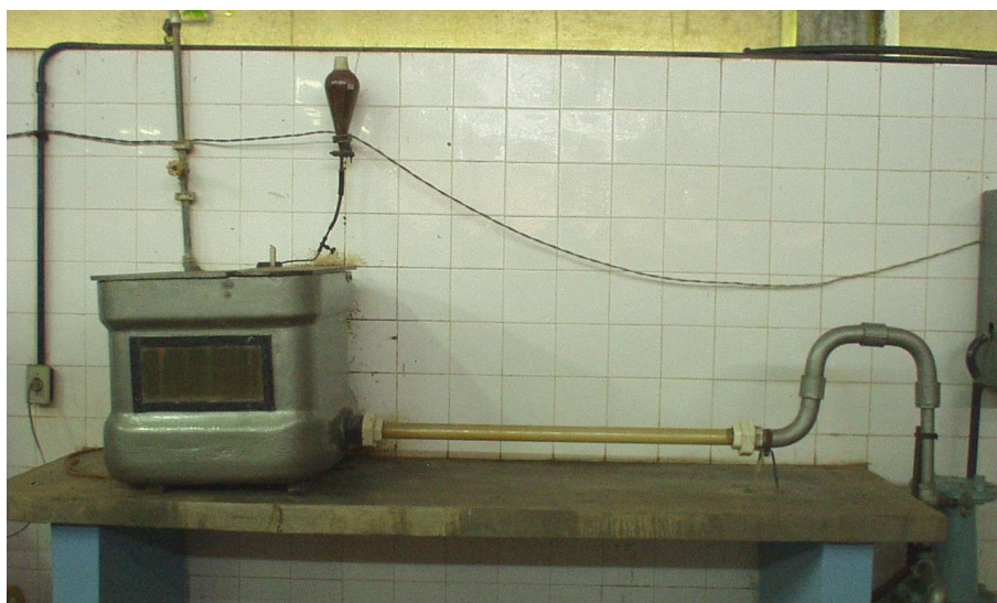
Figura 32 - Foto dos equipamentos utilizados na verificação do regime de escoamento
