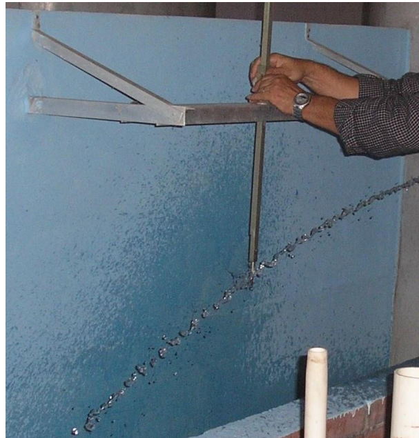
Figura 26 - Perfil do jato de água
