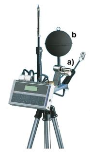
Figura 4 - Estação microclimática BABUC-A. a)psicrômetro; b)termômetro de globo
