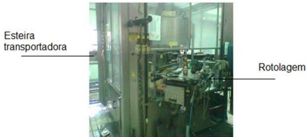
Figura 16 – Rotuladora (Posto 8 e 9) Fonte: AMBEV (2012)
