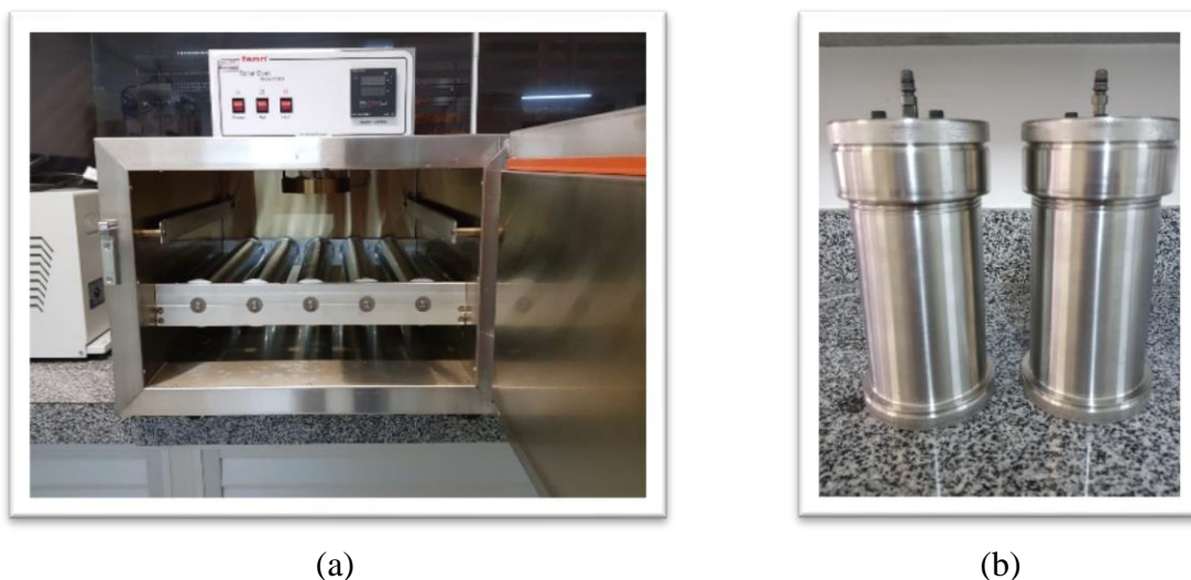
Figura 3.6 – (a) Estufa Roller Oven da marca Fann modelo 705 ES; (b) Células de aço inoxidável.
