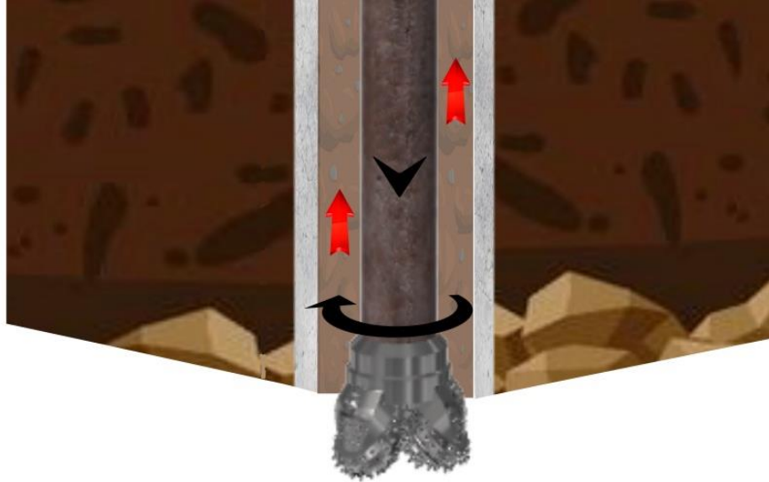
Figura 2.3 – Remoção dos cascalhos com fluidos de perfuração.
