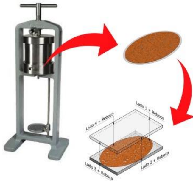
Figura 3.3 – Representação esquemática da medição da espessura do reboco (ER).
