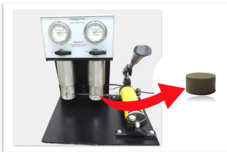
Figura 3.8 – Compactador hidráulico da marca Fann e plug de argila após compactação.
