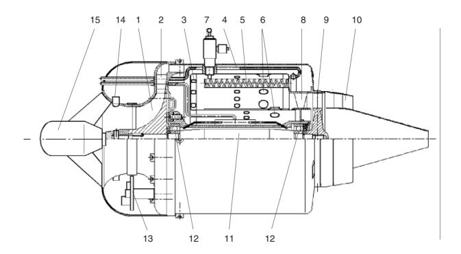
Fig. 2.3 Model-jetturbine
