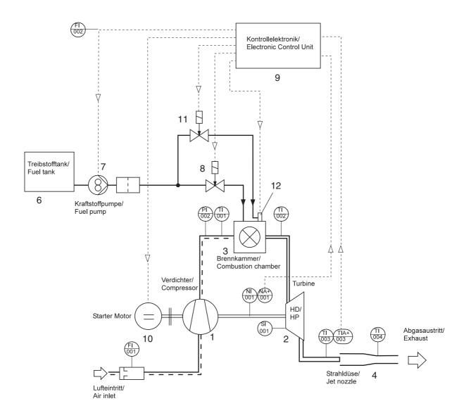
Fig. 2.1 Prozessdiagram Gasturbine
