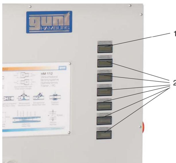
Fig. 2.5 Caixa de distribuição com mostradores digitais
