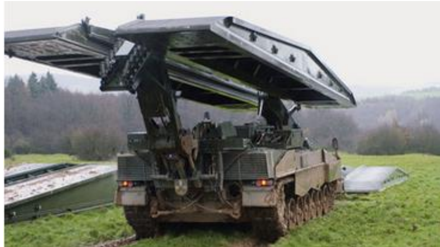
ponte móvel em veículo militar E01D 15/12
