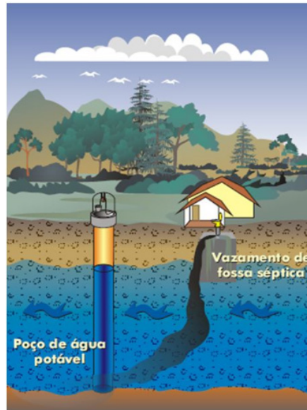
Figura 1- Contaminação da água por meio de fossa negra
