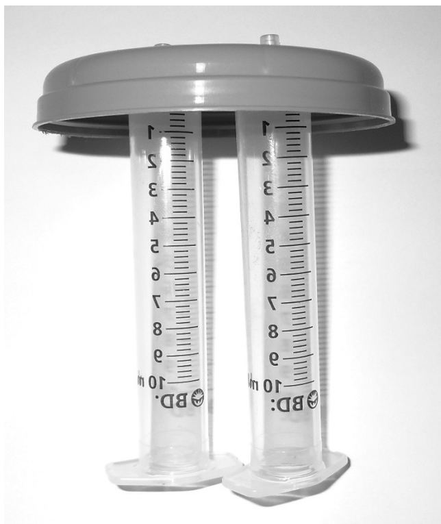
Figura 7. Tampa do copo com as seringas afixadas. Autoria própria.
