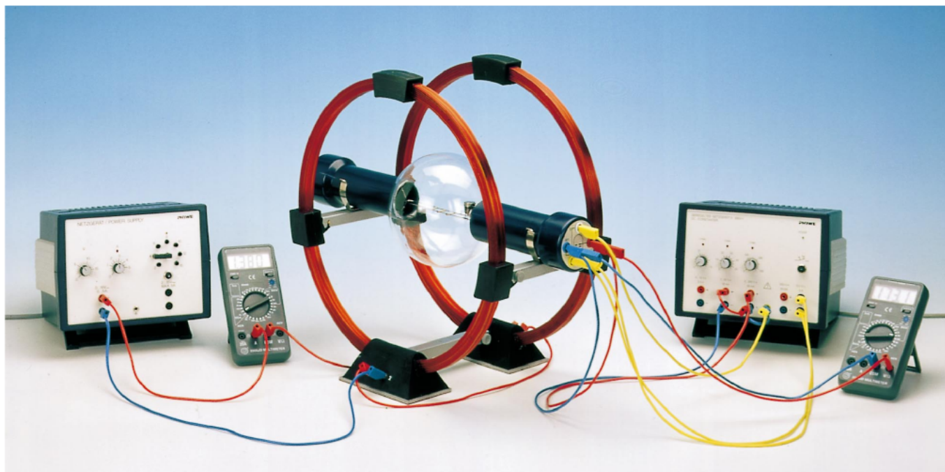
Fig. 49 Configuração do experimento para determinação da relação carga/massa do elétron.
