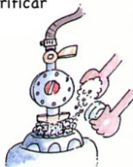
Vazamentos, use espuma de sabão ou detergente no bico. Se houver vazamentos, formará bolhas.
