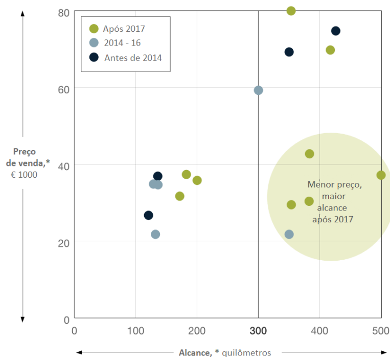
Figura 7 - Preço e alcance do veículo elétrico por ano de lançamento
