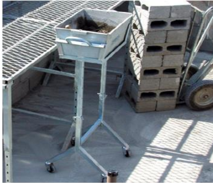
Figura 19 - Caixote para argamassa
