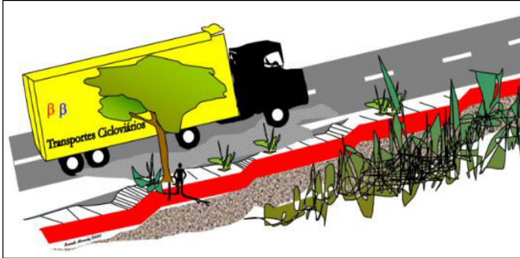
Figura 19 - Detalhe de como é feito o escalonamento de uma rampa de ciclovia.
