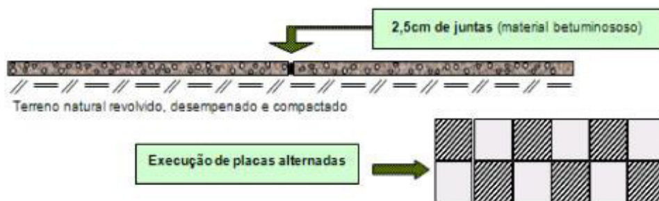
Figura 24 - Pavimento de ciclovia à base de concreto moldado in loco.
