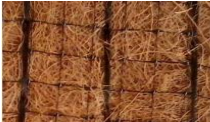
Figura 22: Biomanta composta 100% de fibra de coco
