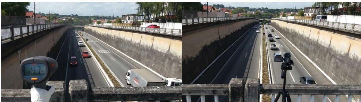
Figura 12 - Medidor de velocidade e filmadora no local de medição
