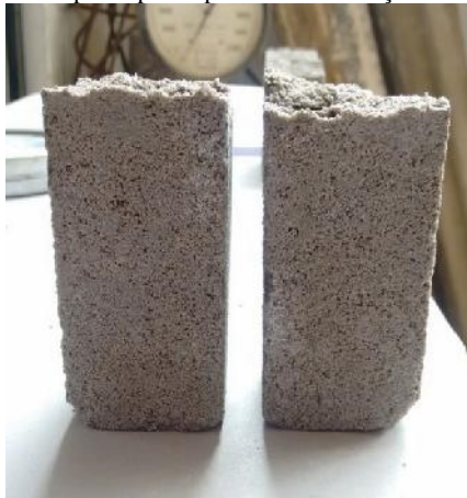
Figura 24 - Aparência porosa de corpo de prova prismático do traço CHE50 rompido à tração na flexão.
