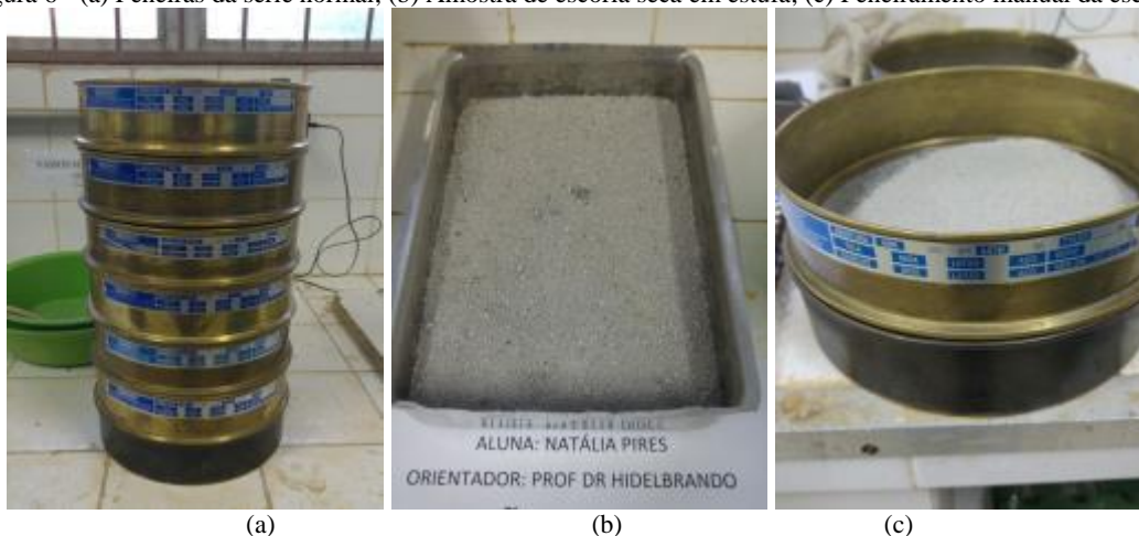
Figura 6 - (a) Peneiras da série normal; (b) Amostra de escória seca em estufa; (c) Peneiramento manual da escória.
