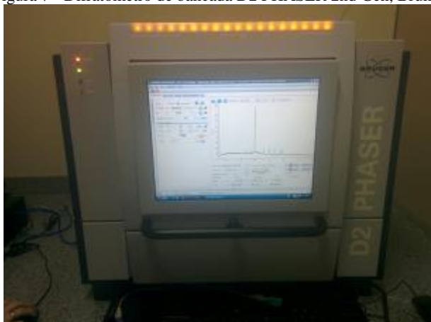
Figura 7 - Difratorômetro de bancada D2 PHASER 2nd Gen, Bruker.
