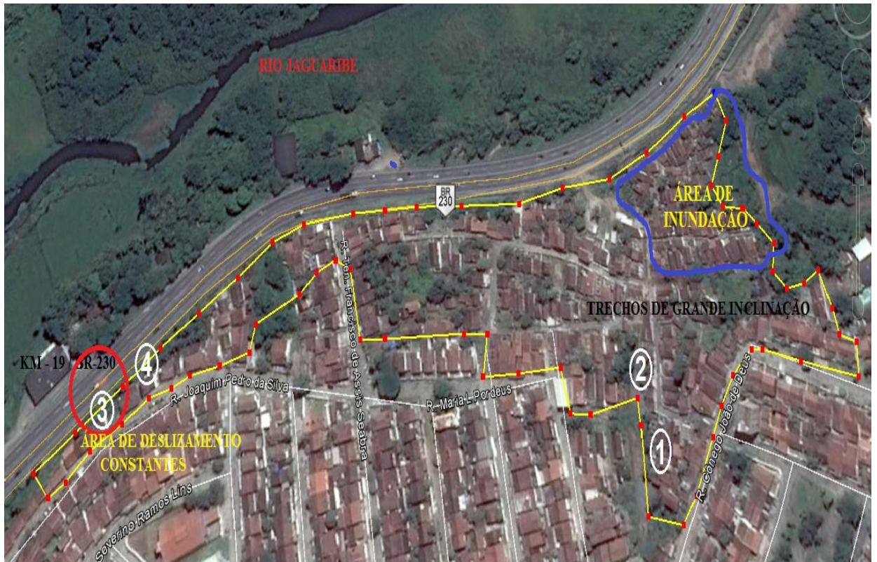
FIGURA 22: Croqui do cenário vulnerável a deslizamentos e inundações – Comunidade Santa Clara, Castelo Branco II
