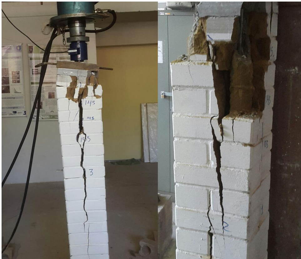
Figura 26 – Ruptura da coluna
