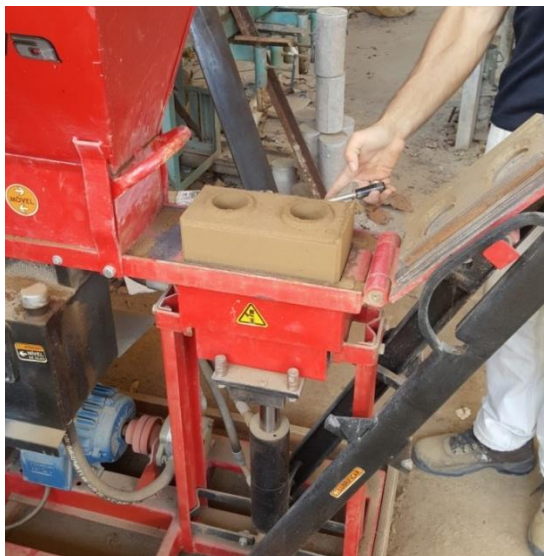
Figura 16 - Moldagem do BTC
