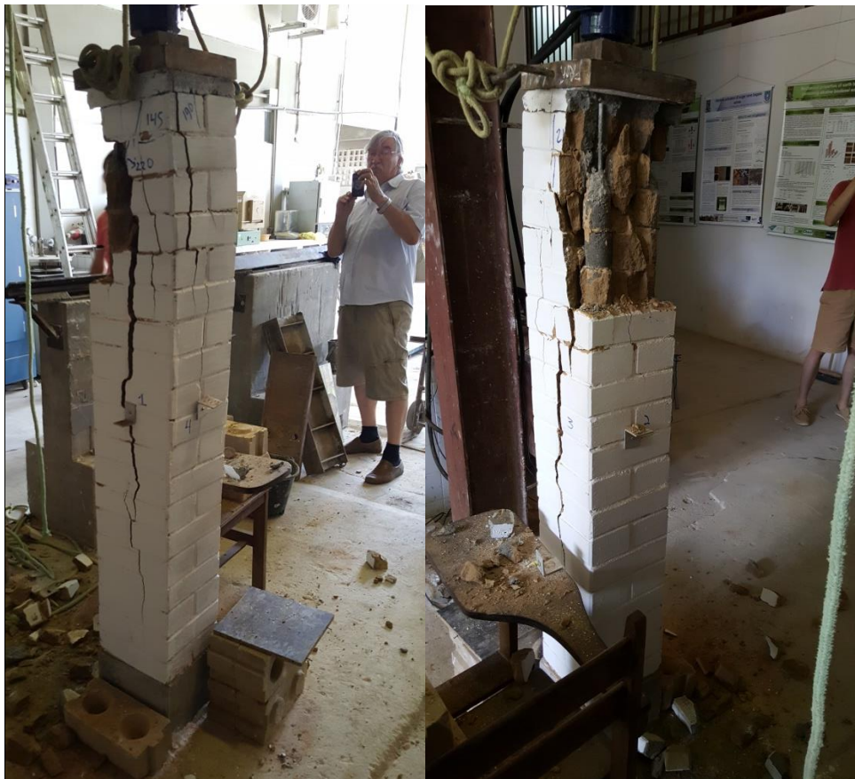
Figura 29 – Ruptura da coluna
