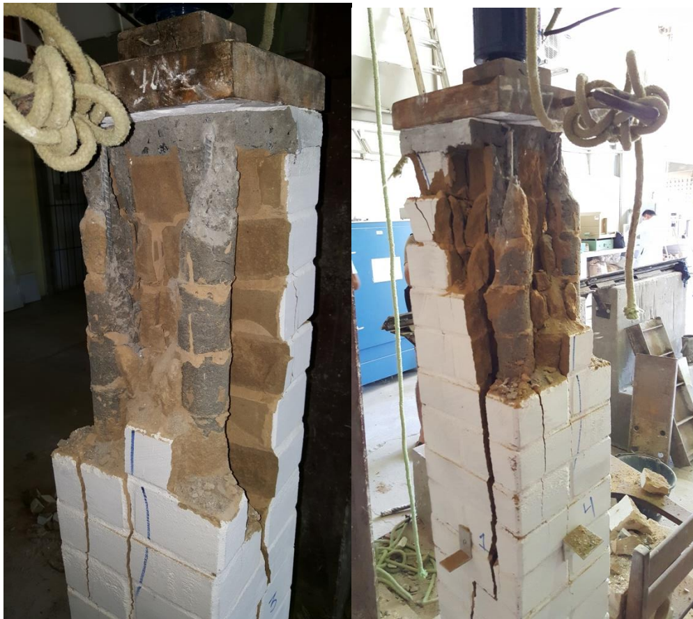
Figura 32 – Ruptura da coluna
